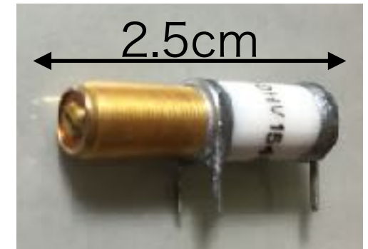
non magnetic trimmer capacitor (Voltronics NMAP40HV)
